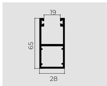
Guida in all. estruso 65x28 con sede per guarnizione antirombo o spazzolino, anche per Girasole.
