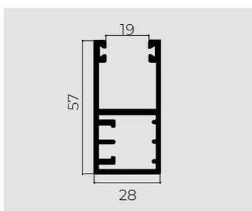
Guida in alluminio estruso 57x28 con sede per guarnizione antirombo o spazzolino, anche per Girasole.
