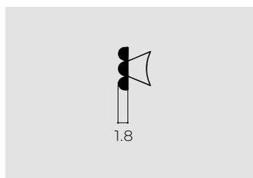
Guarnizione in PVC coestruso maggiorata per guide in alluminio estruso.
