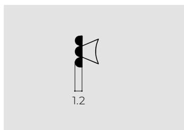
Guarnizione in PVC coestruso per profilo SAR-115, terminali e guide in alluminio estruso.
